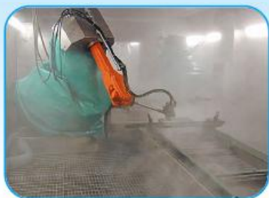
Nettoyage robotisé de patins en usine automobile – 105 l/min et 1000 Bar
