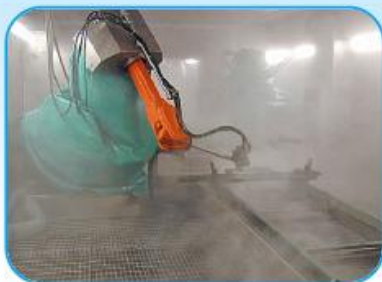
Nettoyage robotisé de patins en usine automobile – 100 l/min et 1000 Bar
