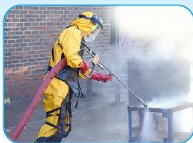
Détartrage – 28 l/min et 1400 Bar
